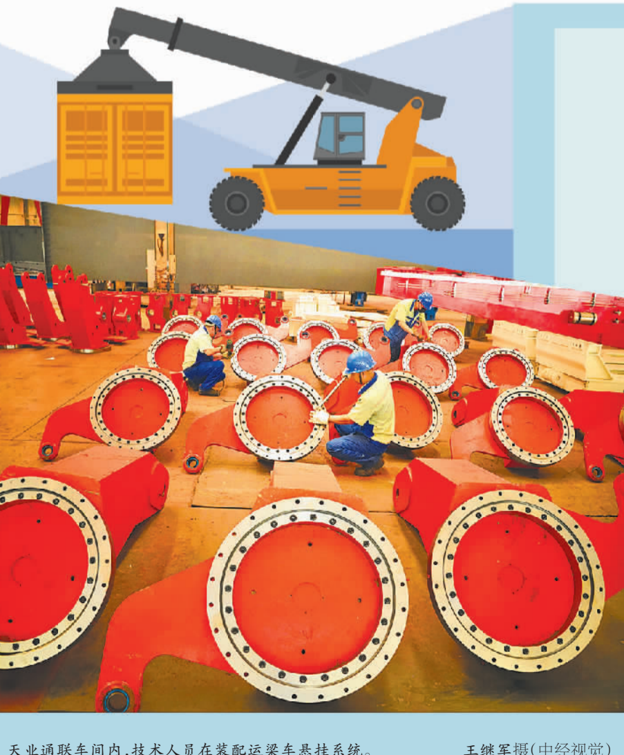
天业通联车间内,技术人员在装配运梁车悬挂系统。
